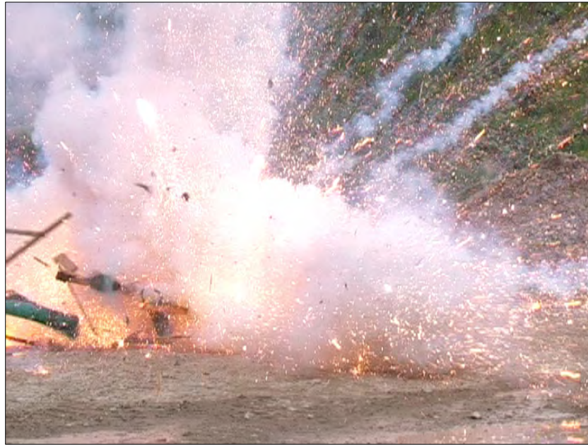
Berstversuch mit Mörserkasten (Bombe verkehrt herum geladen) im Lehrgang
